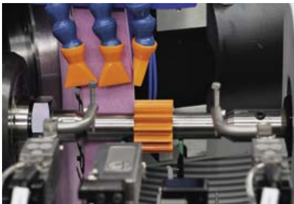
Dettaglio mola/pezzo sulla rettificatrice eProflex
